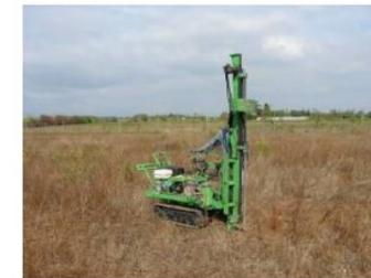
Sondage au pénétromètre
